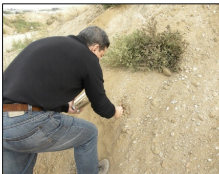
Planta de Tratamiento de RCD de TEC-REC SL (Madrid). Precibado Hormigón.
